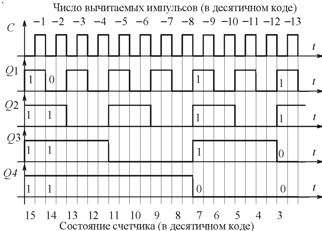
Рис. 8.4. Временные диаграммы в вычитающем двоичном счетчике с последовательным переносом
